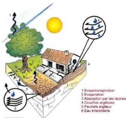
Un sol argileux change de volume selon son humidité comme le fait une éponge ; il gonfle avec l'humidité et se resserre avec la sécheresse, entraînant des tassements verticaux et horizontalement, des fissurations du sol.
